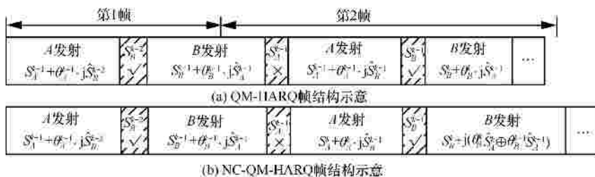
图 2 QM-HARQ 与 NC-QM-HARQ 方案帧结构示意图
